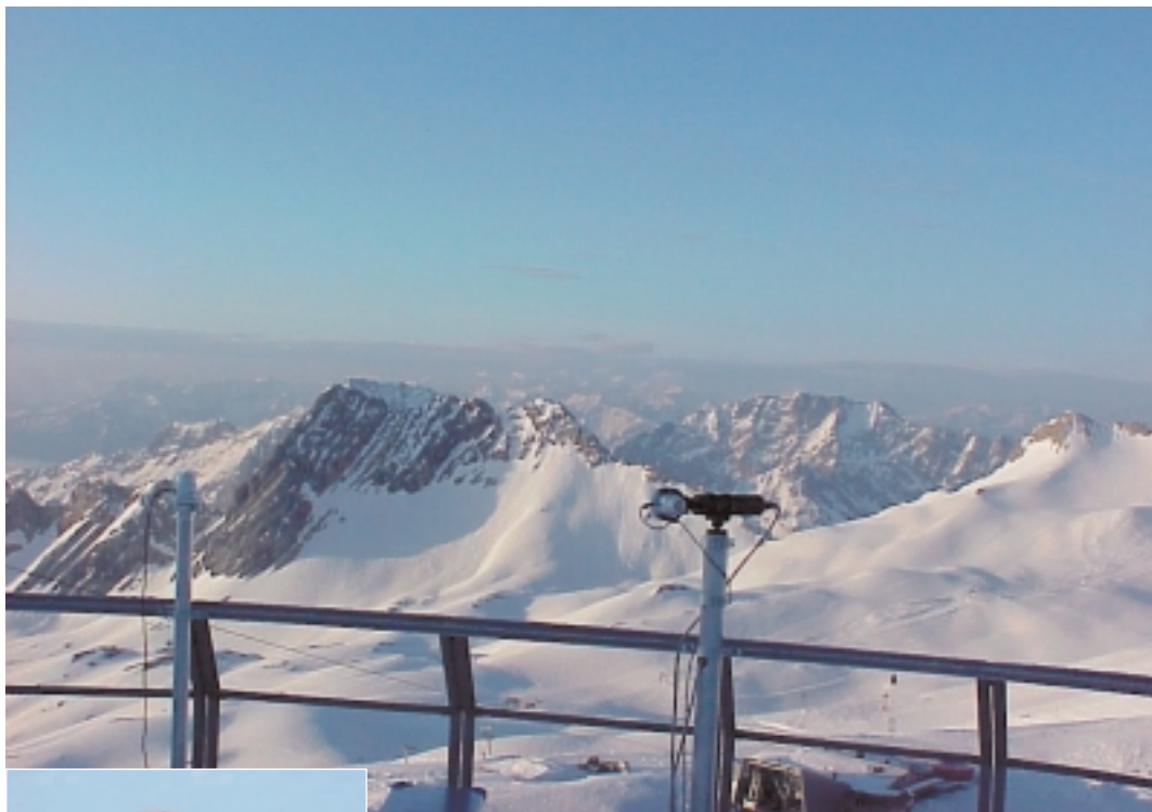
Das System ASCARATIS misst die UV-Strahlung gewichtet nach ihrer Sonnenbrand auslösenden Wirkung – hier im Skigebiet an der Zugspitze.
