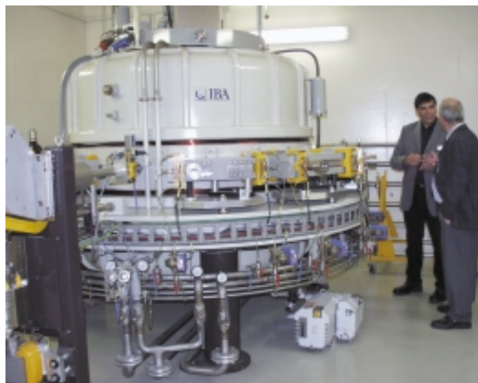
Der Elektronenstrahlbeschleuniger in Saal a. D. verfügt über 10 MeV Beschleunigungsenergie und 150 MW Strahlleistung.
