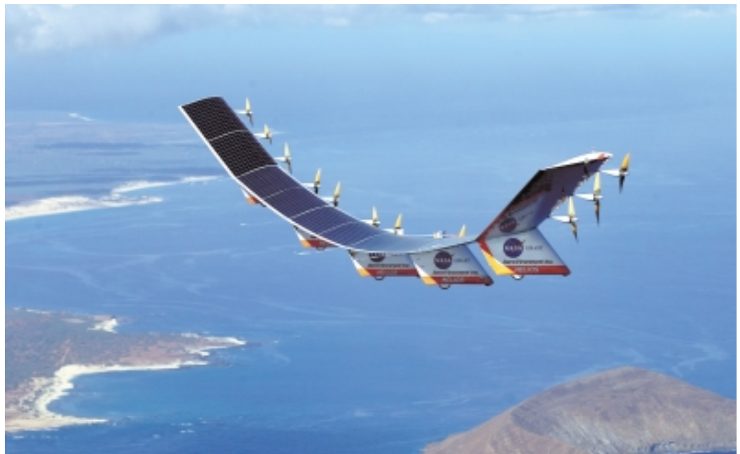
Solarzellen und eine Tragfläche aus Faserverbundwerkstoffen in Ultraleichtbauweise ermöglichen eine Flughöhe von 23 km des Helios-Solarflugzeuges. (Foto: NASA)
