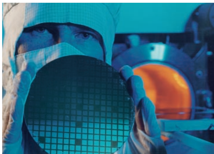
Wissenschaftler im Reinraum mit einer prozessierten Siliciumscheibe. Im Hintergrund eine MOCVD-Anlage zur Schichtabscheidung. (Foto: Kurt Fuchs)
