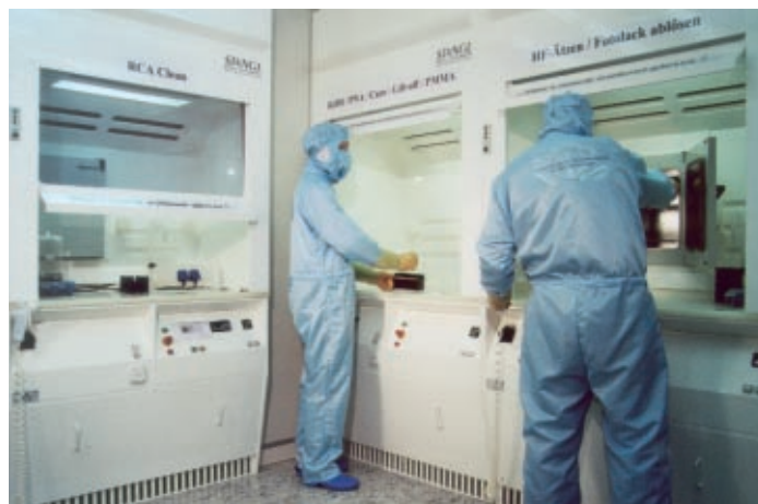
Arbeiten im Reinraum sind Voraussetzung für die Herstellung nanoelektronischer Bauelemente. (Foto: Institut für Physik, Universität der Bundeswehr München)
