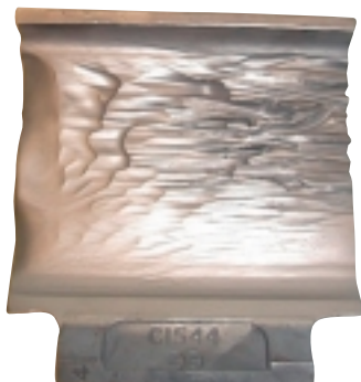
Verschleiß einer Stahl-Wurfschaufel
