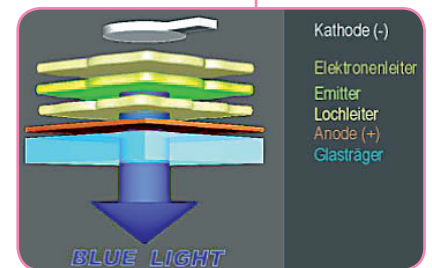
Schematischer Aufbau einer Mehrschicht-OLED-Diode
