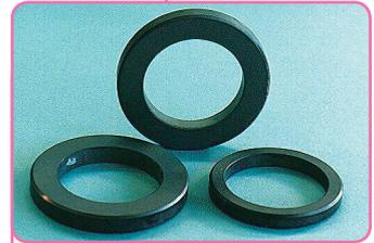
Mit der neuen Diamant-Gleitschicht läuft die Gleitringpaarung sehr ruhig, mit niedrigem Reibwert und geringer Temperaturentwicklung und bis Testende (4 h) nahezu verschleißfrei.
