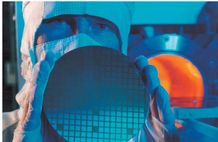
**Wissenschaftler im Reinraum mit einer prozessierten Siliciumscheibe. Im Hintergrund eine MOCVD-Anlage zur Schichtabscheidung.**
