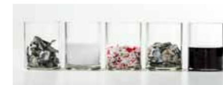
Fünf Komponenten werden aus den gesammelten Dosen wiedergewonnen: Weißblech, Treibgas (TRIGAS®), Kunststoffmahlgut PE/PP, Aluminium und PU-Prepolymer (PREPUR®).
