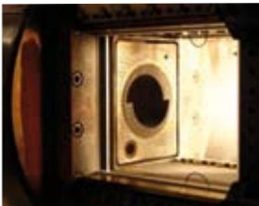
Blick auf die Brenneröffnung in der optisch zugänglichen Brennkammer des Hochdruckprüfstands
