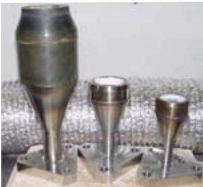
SiSiC-Schaumkeramik und Al<sub>2</sub>O<sub>3</sub>-Mischerstruktur während des Betriebs, Pilotbrenner verschiedener Leistung
