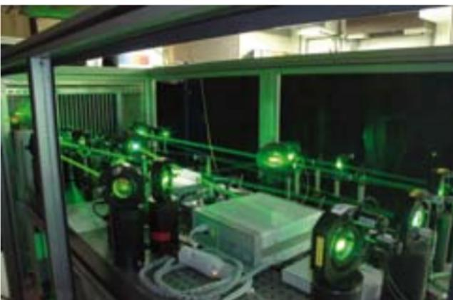
Laserpulsstreckter des 1D-Raman-Messsystems während des Betriebs
