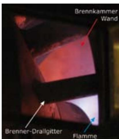
Die Brennkammer im Betrieb. Blick durch den Brenner auf die Flamme.
