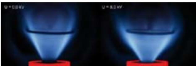
Eigenleuchtenaufnahme einer Drallflamme ohne (links) und mit (rechts) aktivem elektrischen Feld
