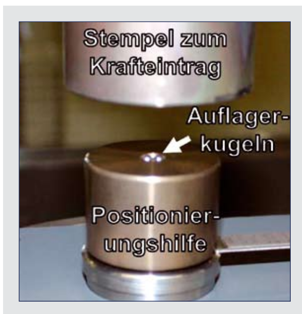
Bild 4 Aufbau zur Bestimmung der Bruchfestigkeit im 4-Kugel-Biegeversuch nach Danzer [2] .
