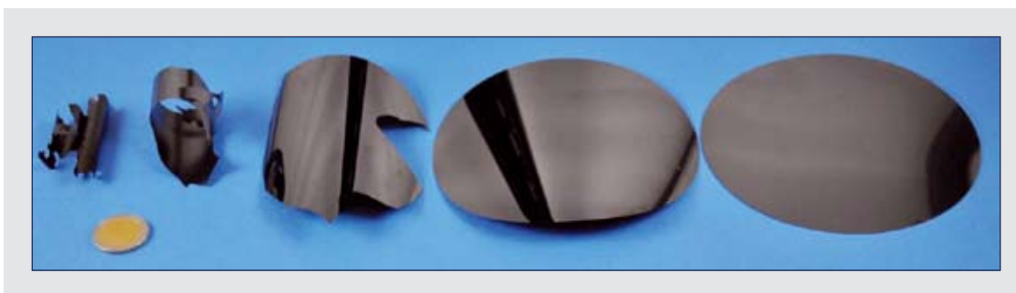
Bild 3 Entwicklungsstadien nanokristalliner Diamantfolie während der Projektlaufzeit des BFS Forschungsverbundes ForLayer: von spratzigen Stücken mit matter Oberfläche und starker Verkrümmung hin zu ebenen „Diamantwafern“ mit hoher Oberflächenqualität und einem Durchmesser von 140 mm.
