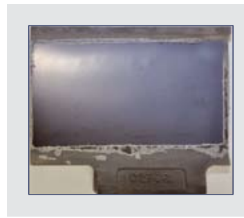
Bild 6 Wurfschaufel der Fa. Rösler, die auf der Nutzfläche zum Schutz vor Abrasivverschleiß mit Diamantfolie beklebt ist.
