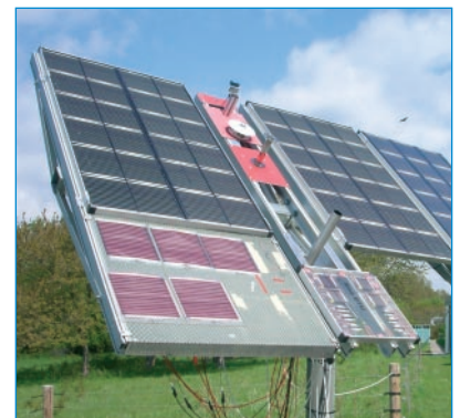
LARGECELLS: Testanlage eines OPV-Moduls ■
