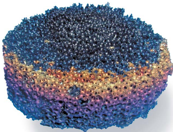
Offenzelliger Keramikschaum auf Polysiloxanbasis. Die Polysiloxanschmelze schäumt bei 300 °C auf und wird anschließend durch die Pyrolyse in Stickstoffatmosphäre keramisiert.
