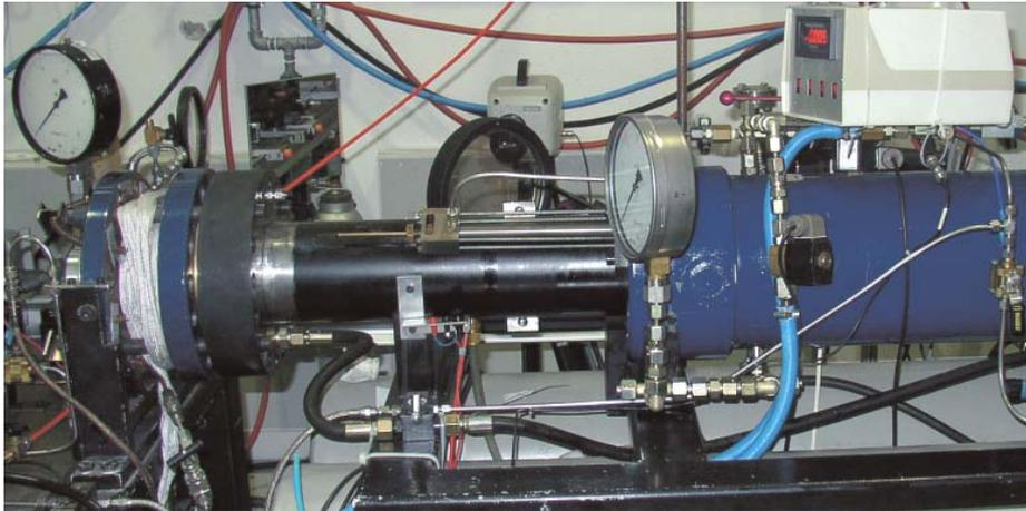
**Bild 2:** Experimentelle Forschung zum Verbrennungsprozess kann an Versuchsmotoren, Verbrennungszellen oder, wie im Bild gezeigt, an Einhubmaschinen durchgeführt werden. Pro Experiment simuliert die Einhubmaschine einen einzigen Verdichtungs-, Verbrennungs- und Expansionsvorgang.
