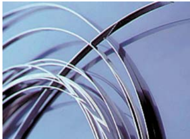
Bild 2: Die HTS-Drähte der ersten Generation bestehen aus einem Komposit von Silber und Filamenten aus \text{Bi}_{1,8}\text{Pb}_{0,3}\text{Sr}_2\text{Ca}_2\text{Cu}_3\text{O}_{10} (BSCCO-2223). (Foto: American Superconductor Corp.)
