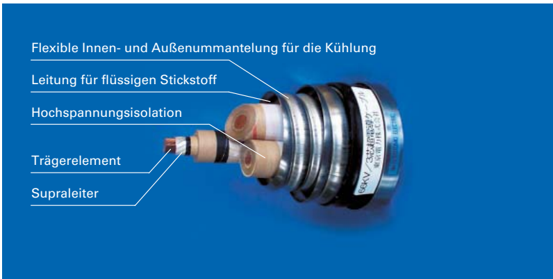
Bild 4: Ein aktuelles HTS-Kabel im Querschnitt: Die HTS-Drähte sind spiralförmig um jeweils einen von drei hohlen Kupferkernen gewickelt. Dieses Kabel ist 100 m lang. (Foto: Sumitomo Electric Industries.)
