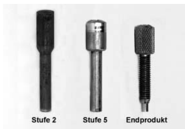
Bild 1: Umformstufen bei der Herstellung von Schrauben
