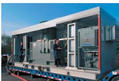
Bild 6: Schutz vor Spannungsinstabilitäten im Hochspannungsnetz. Dieser Synchronmotor zur dynamischen Regelung der Blindleistung im Netz ist so kompakt, dass er in einen Lastwagenanhänger passt. (Foto: American Superconductor Corp.)
