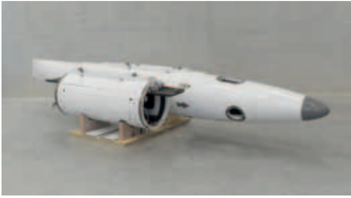
Hier ist CFK bereits im Einsatz: Instrumententräger und vollständiger Unterflügelbehälter für das Forschungsflugzeug HALO, entwickelt und hergestellt von der Fa. Aerostruktur
