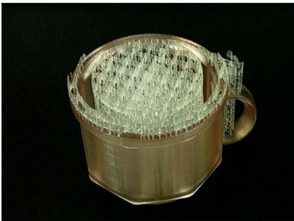
Bild 5: Rapid-Prototyping-Modell einer Mokka- tasse hergestellt mit Hilfe von Laserstereolithographie (LSL) aus den Geometriedaten, der im rechten Bild dargestellten virtuellen Mokka- tasse. Das noch sichtbaren Stütz- gitter kann zur Bemusterung leicht entfernt werden
