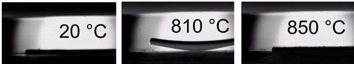
Abb.3: Verwölbung eines Laminates aus Heraeus CT 700-Folien
