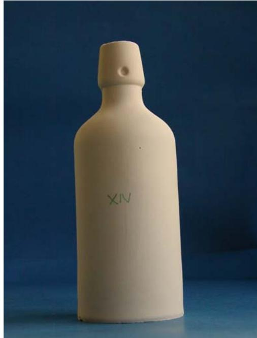
Bild 3: Unglasierte Flasche mit 30 Masse% Borglas
