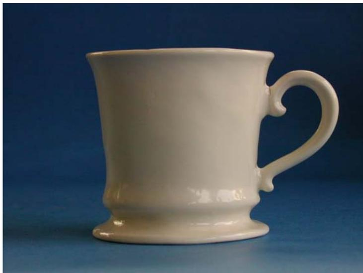
Bild 2: Glasierte Tasse mit 25 Masse% Borglas
