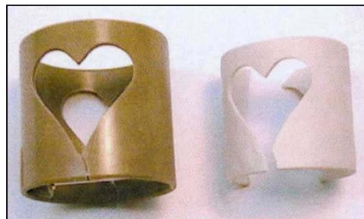
Abb. 2: geometriebedingte Rissbildung
