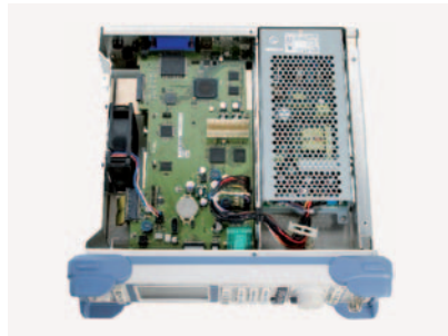
Kühlsystem in einem Messgerät
