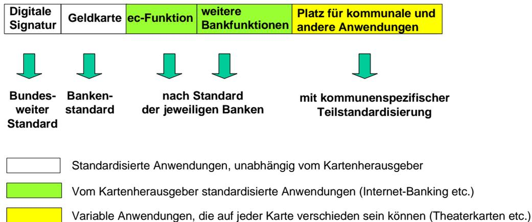
Abbildung 12: Speicheraufbau der multifunktionalen Chipkarte
