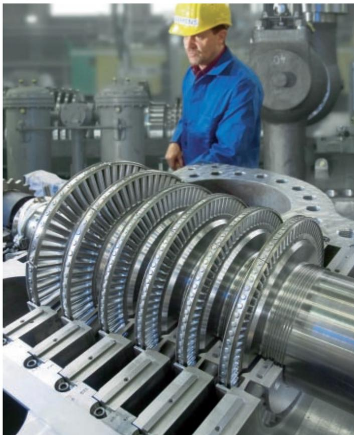
Dampfturbine der Siemens AG (Quelle: Siemens AG)
