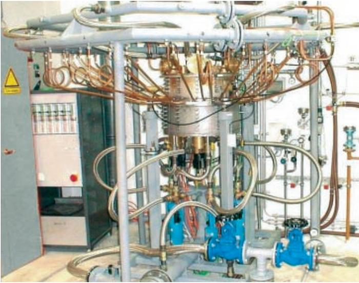
**Versuchs-Ringbrennkammer einer Gasturbine für thermoakustische Messungen.**
