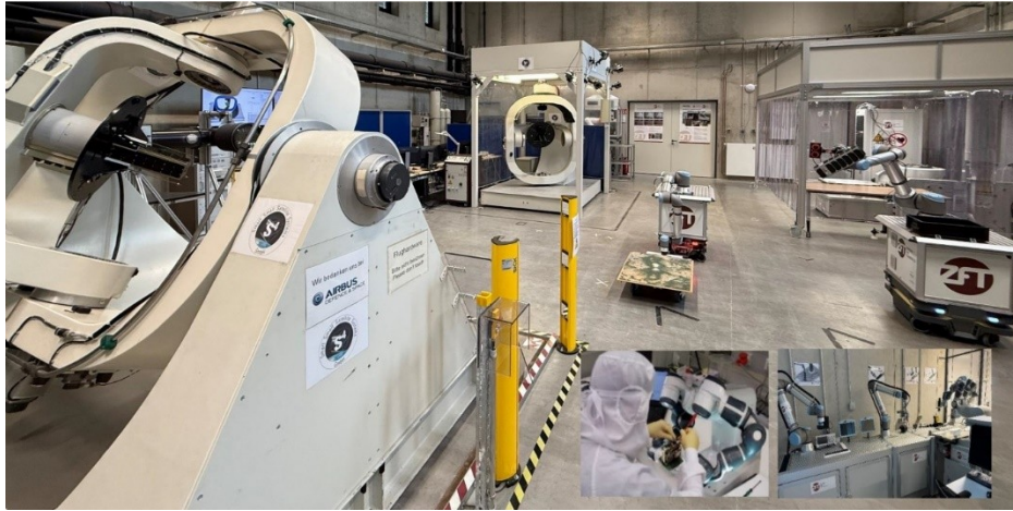
Bild 6: Blick in die „Forschungsfabrik Kleinsatelliten“ mit Dynamik-Testgeräten, Rütteltisch und mobilen Robotern zur möglichst realistischen Simulation der Weltraumumgebung im Labor.
