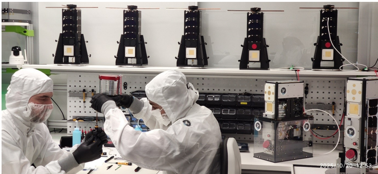
Bild 5: Der Reinraum in Würzburg füllte sich mit kompletten Satelliten: Auf dem Board links die 3 TOM-Satelliten, rechts 2 CloudCT-Vorbereiter. Auf dem Tisch stehen 2 fertige CuBy, während der 3 gerade integriert und getestet wird. (Quelle: Prachit Kamble, S 4 GmbH, Würzburg)
